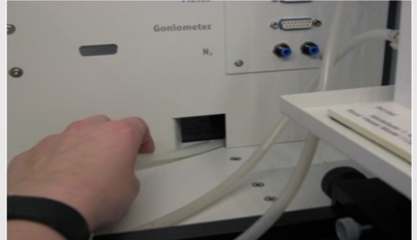
Рис.3: Трубки, проложенные через рабочий канал
