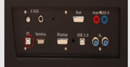
Fig. 3: Conexión del ordenador
