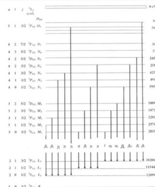
Рис. 2: Схематическое изображение энергетического уровня вольфрама ( $Z = 74$ )
