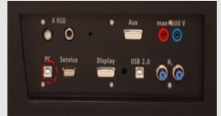
Рис. 5: Подключение компьютера
