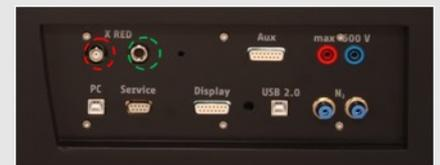
Рис. 2: Подключение многоканального анализатора
