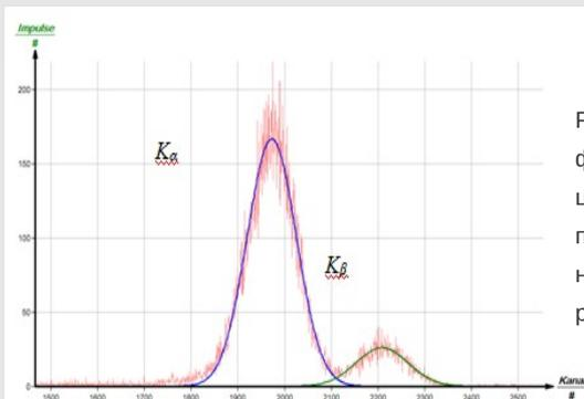
Рис. 7б: Линии флуоресценции цинка с подогнанным нормальным распределением
