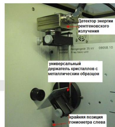
Рис. 3: Установка гониометра
