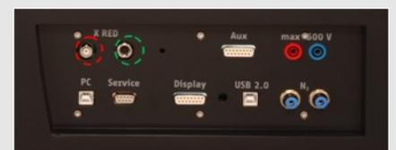
Fig. 2: Conexión del analizador multicanal
