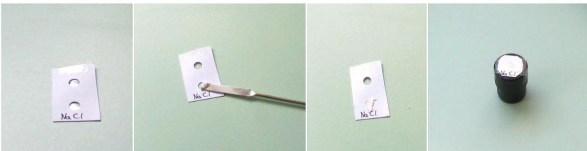
Abb. 6a-cd: Probenpräparation. a: gelochtes Papier (3 Lagen) mit Klebefolie; b: Aufbringen des Pulvers, c: Glattstreichen, d: auf der entsprechenden Blende montieren
