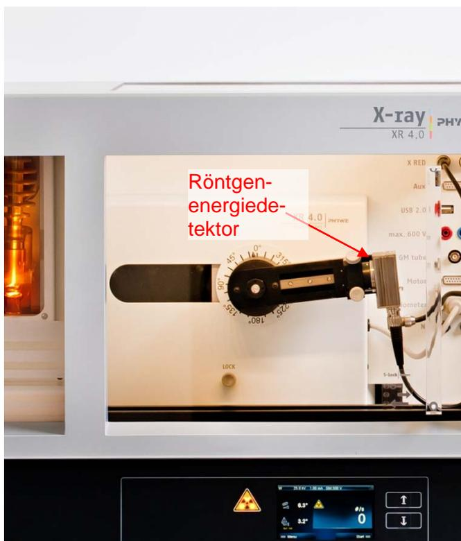
Abb. 4: Versuchsaufbau am Goniometer
