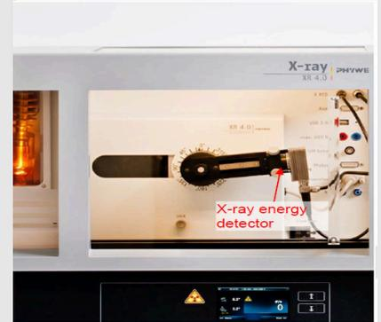
Fig. 3: Montaje del goniómetro
