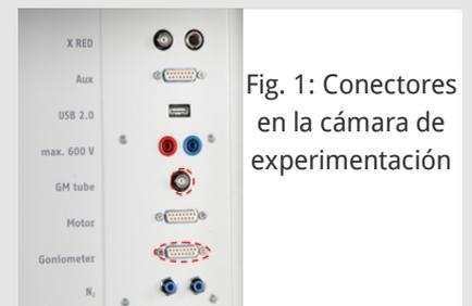
Fig. 1: Conectores en la cámara de experimentación
