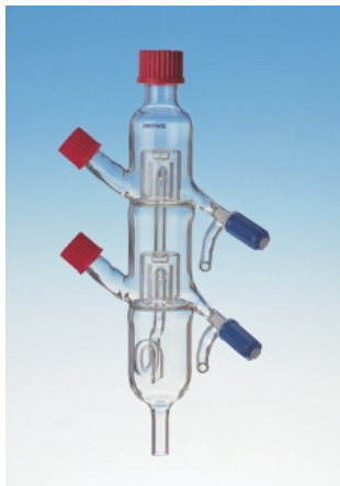
Modelo de columna con bandeja de burbujas
