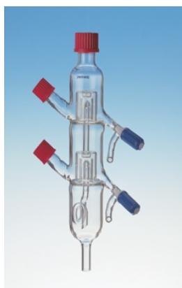
Modelo de columna con bandeja de burbujas
