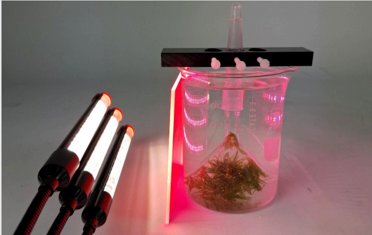
Montage expérimental avec lampe à photosynthèse et filtre coloré rouge
