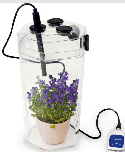
Versuchsaufbau mit Reaktionskammer, Pflanze und Sauerstoff-Sensor
