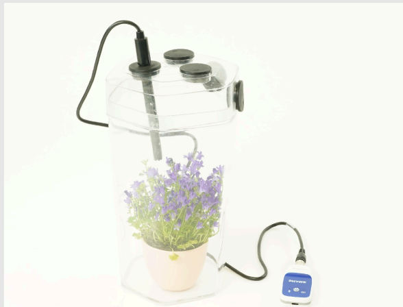
Montage d'expérience avec chambre de réaction, plante et capteur
