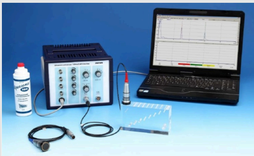
Рис. 1: Оборудование для ультразвуковой эхографии, экспериментальная установка
