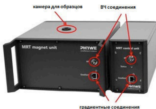
Рис.2: Подключение магнита и блока управления
