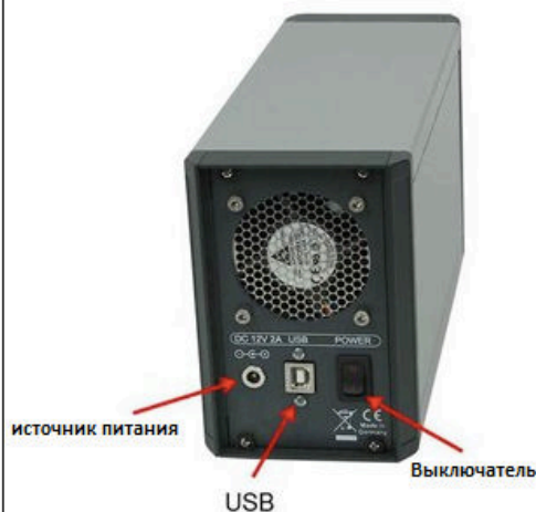
Рис.3: Соединения на задней панели блока управления
