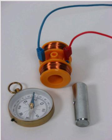
Spule mit Eisenkern und Kompass
