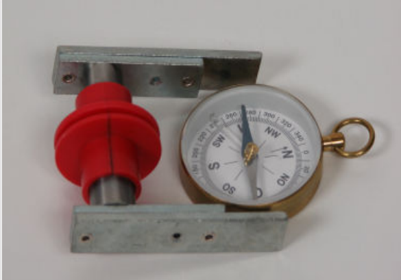
Etude du champ magnétique entre les pièces polaires
