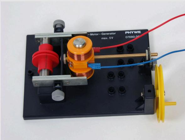
Versuchsaufbau des schematisch nachgebildeten Elektromotors
