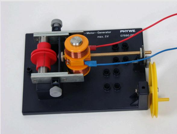
Versuchsaufbau des schematisch nachgebildeten Elektromotors
