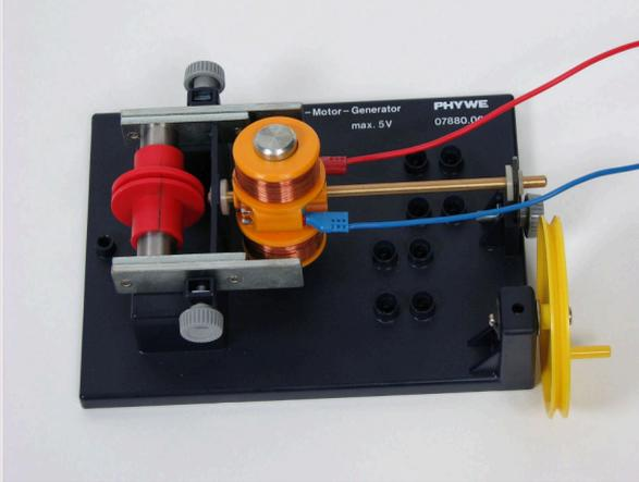
Versuchsaufbau des schematisch nachgebildeten Elektromotors
