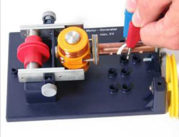
Montaje experimental de un motor eléctrico con inversor de corriente
