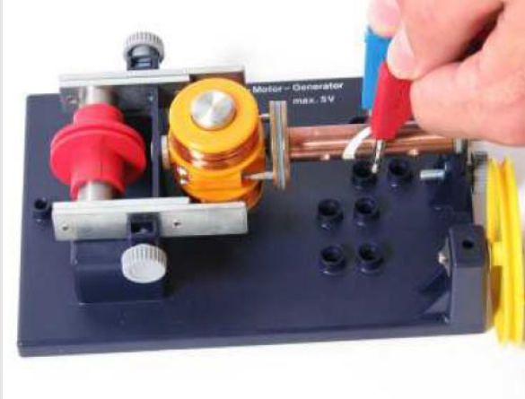
Montage expérimental d'un moteur électrique avec inverseur de courant
