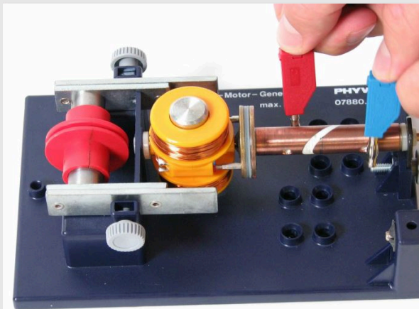
Экспериментальная установка электродвигателя с коммутатором (инвертором тока)
