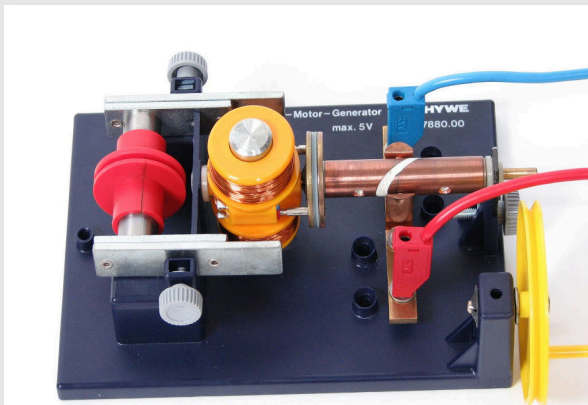
Montaje esquemático de un motor eléctrico (rotor: electroimán, estator: imán permanente)
