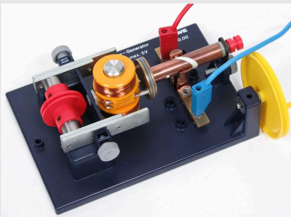
Structure schématique d'un moteur électrique (rotor : électroaimant, stator : aimant permanent)
