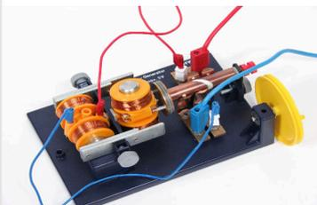
Motor de derivación 2
