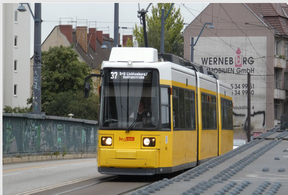
Трамвай города Берлина, приводимый в движение двигателем последовательного возбуждения
