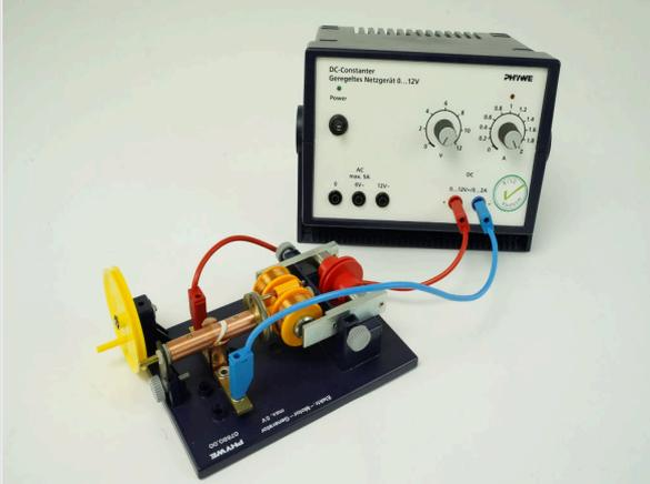
Elektromotor an Spannungsquelle
