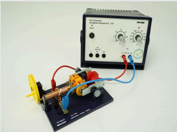
Motor eléctrico conectado a una fuente de tensión
