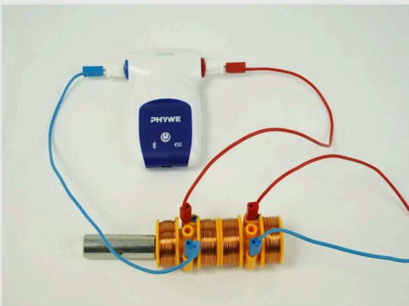
Versuchsaufbau 1: Einfacher Transformator
