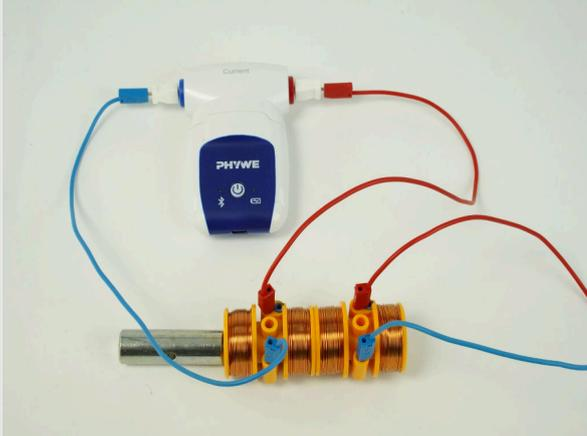
Versuchsaufbau 1: Einfacher Transformator
