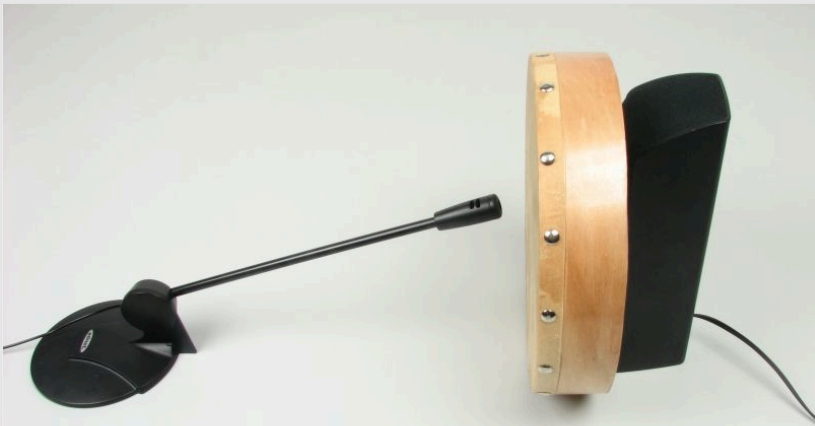
Rahmentrommel vor dem Lautsprecher, das Mikrofon zentral vor Trommelmembran
