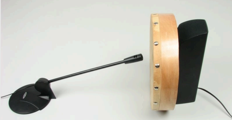
Tambour sur cadre devant le haut-parleur, le microphone devant le centre de la membrane du tambour
