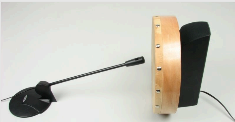
Барабан перед громкоговорителем, микрофон по центру перед мембраной барабана
