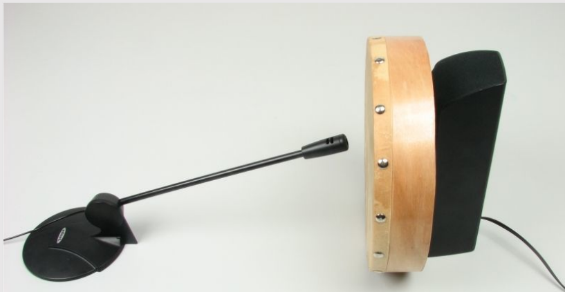
Барабан перед гучномовцем, мікрофон по центру перед мембраною барабана
