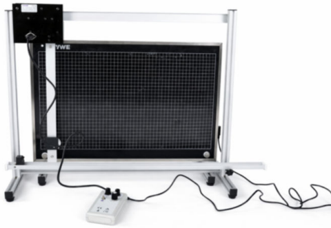
Versuchsaufbau zur zweidimensionalen Aufspaltung der Bewegung
