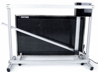
Versuchsaufbau zur zweidimensionalen Aufspaltung der Bewegung
