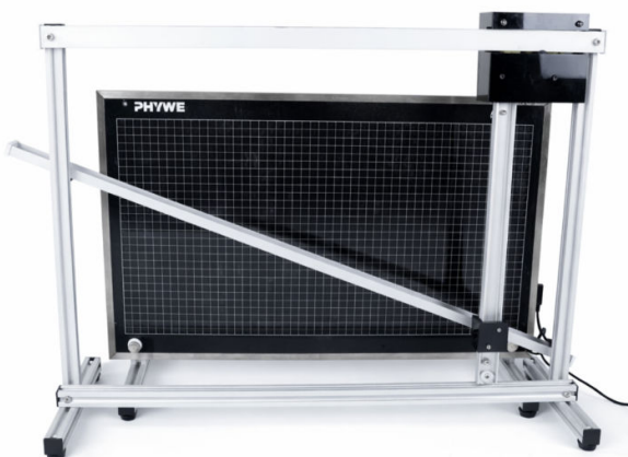
Experimenteller Aufbau der Schiefen Ebene
