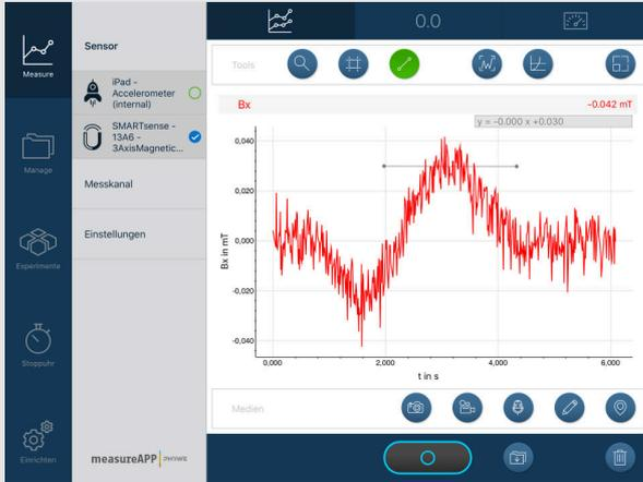
Mesure de l'aimant terrestre sur le plan horizontal
