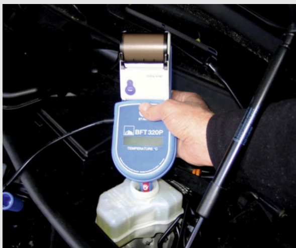
Prueba del contenido de agua del líquido de frenos
