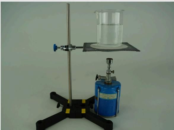
Versuchsaufbau mit Stativ, Butanbrenner und Becherglas
