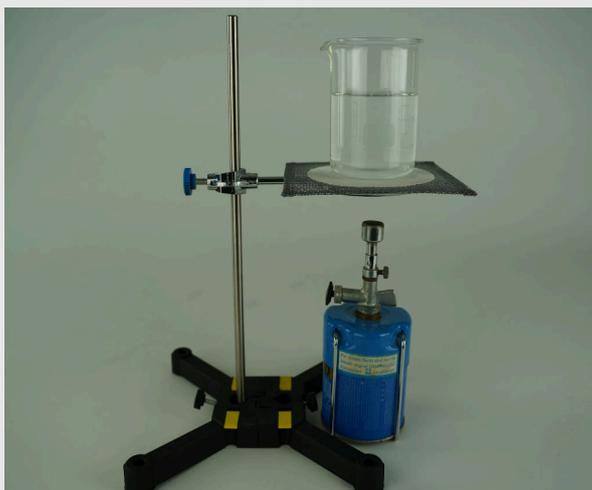
Versuchsaufbau mit Stativ, Butanbrenner und Becherglas
