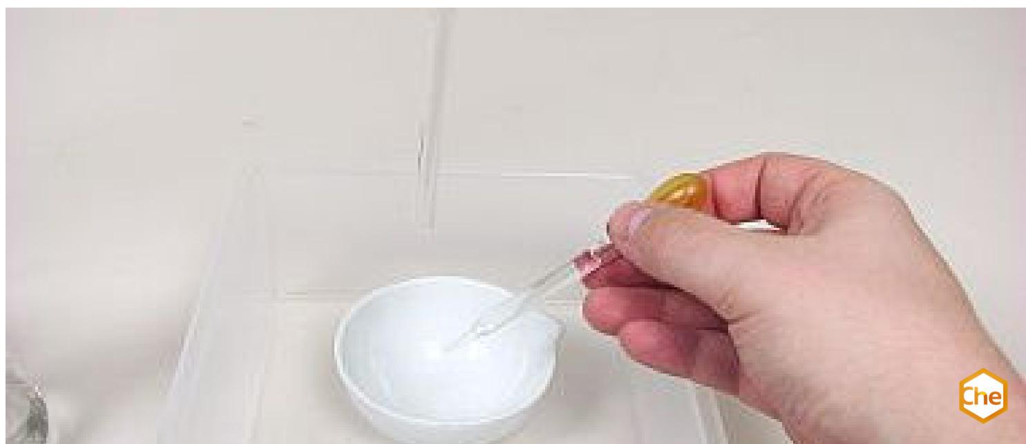
En este experimento de los alumnos, se reproduce el modelo de un extintor. En este caso, el dióxido de carbono (representado por el carbonato de sodio y el ácido clorhídrico) forma una espuma con el detergente, que se rocía sobre la gasolina encendida y la llama se apaga (al desplazar el oxígeno).
