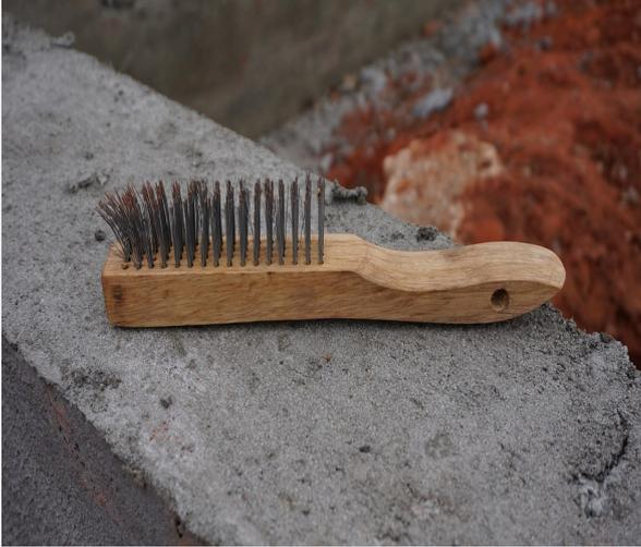
**Drahtbürsten können verrostete Eisenteile reinigen**
