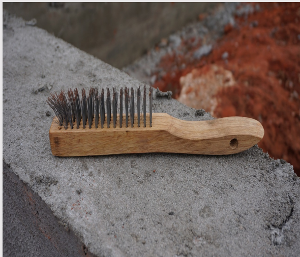
Дротяні щітки можуть очистити іржаві залізні деталі
