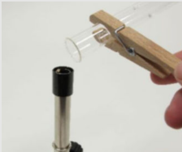
Образец кислородсодержащего водорода с использованием горелки Бунзена
