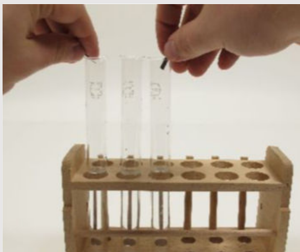
Zugabe des Magnesiumbandstückchens
