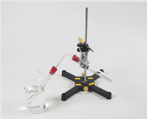
La producción de poliamida mediante una reacción de condensación.
