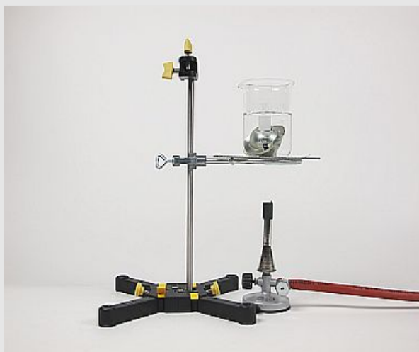
Die Herstellung von Polystyrolschaum aus Perl-Polystyrol.
