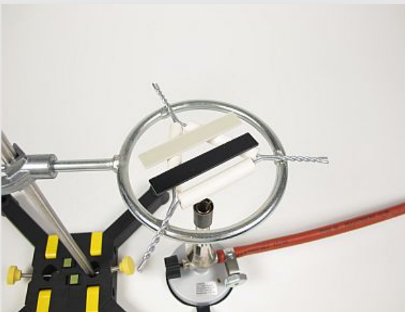
Untersuchung des Verhaltens von Thermoplasten sowie Duroplasten bei Erwärmung.
