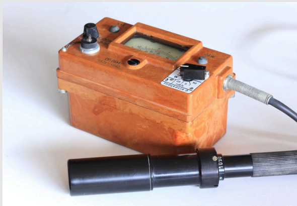
Détecteur Geiger-Müller avec affichage visuel et signal acoustique
