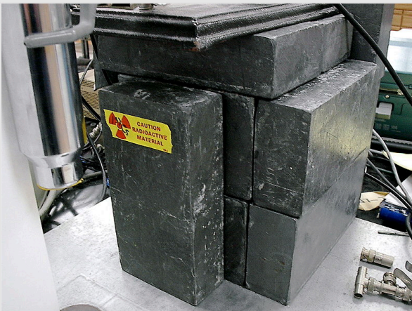
Matière radioactive blindée par du plomb
