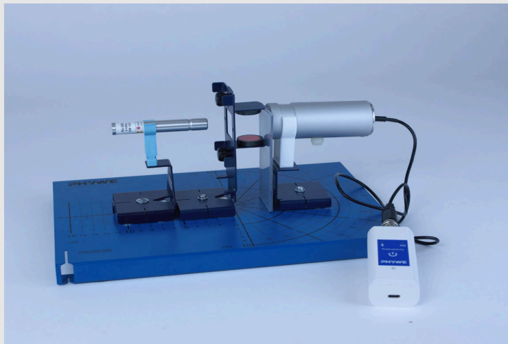
Montaje completo de la prueba con la placa de plomo instalada
