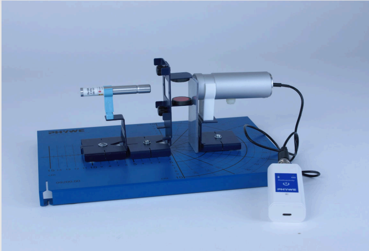
Montage complet d'expérience avec plaque de plomb installée
