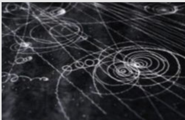
Различные типы излучения в магнитном поле, видимые с помощью камеры Вильсона
