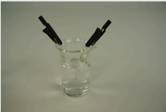
Befestigung der Elektrodenbleche am Rand des Becherglases.
