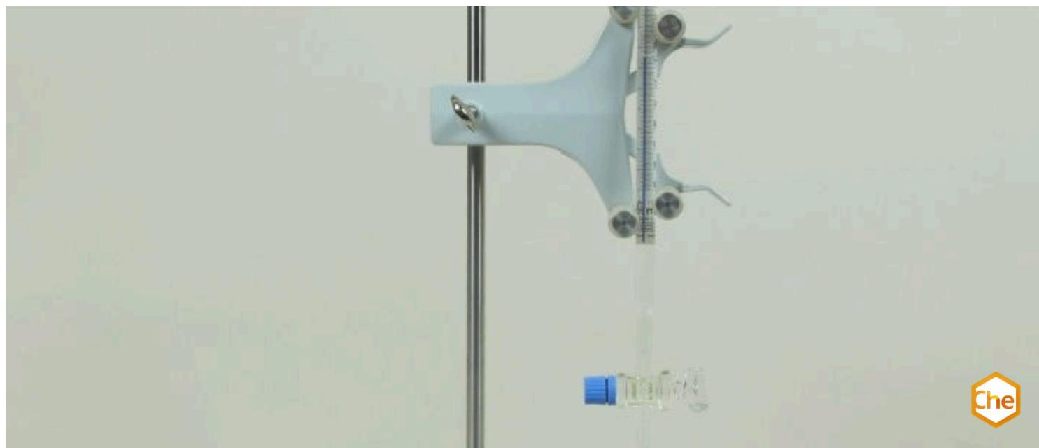
P7510500 - En este experimento se determina la concentración desconocida de una solución ácida utilizando un indicador adecuado. Este experimento es un ejemplo clásico de valoración ácido-base.
